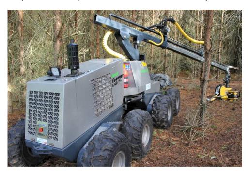
Figura 2.1: Castor florestal equipado como ceifeira para bioenergia com uma cabeça de corte de Kesla.
